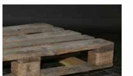
Keine vorgeschriebene Kennzeichnung mehr lesbar
