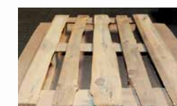
Unzulässiges Bauteil, z. B. untermaßig, morsch, Baumkante
